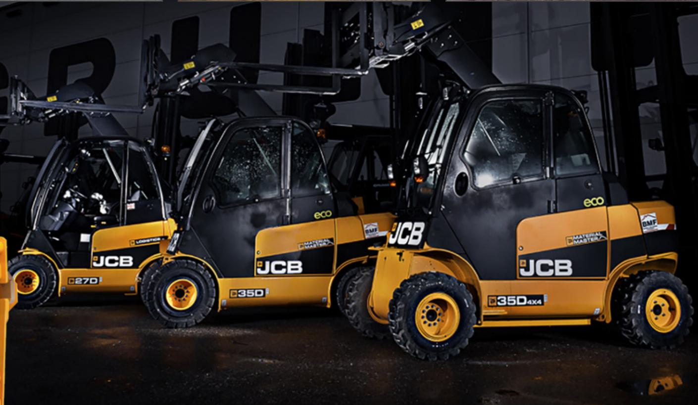
1997 erfand JCB den Gabelstapler neu. Heraus kam dabei der JCB Teletruk, ein Gabelstapler mit einem Teleskopausleger anstelle eines vertikalen Hubmasts. Diese einzigartige Konstruktion verringert Betriebskosten, spart Zeit und Platz, außerdem verbessert sie die Arbeitssicherheit. All dies kann enorme finanzielle Einsparungen bedeuten.
